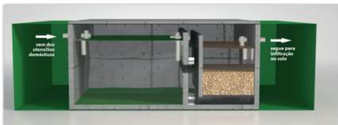
Figura 6-24 - Sistema fossa séptica e filtro biológico.
