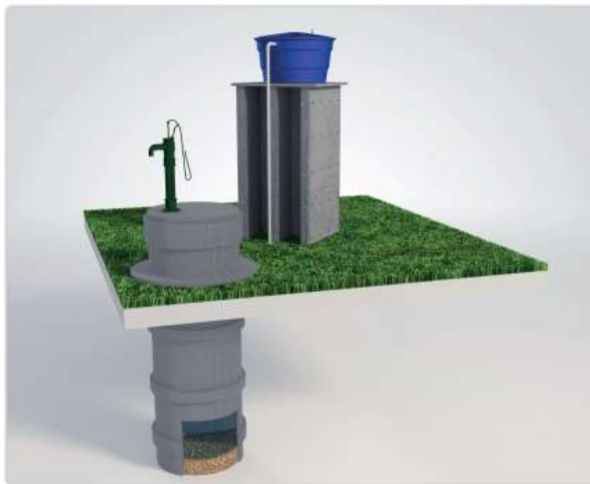
Figura 6-31 - Poço escavado protegido
