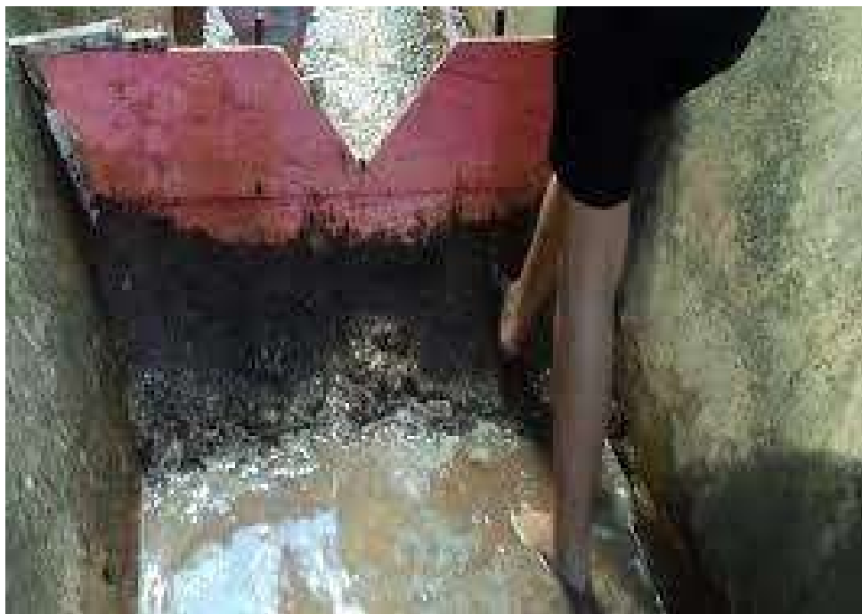
Figura 9-2 - Vertedor triangular em chapa de madeira compensada
