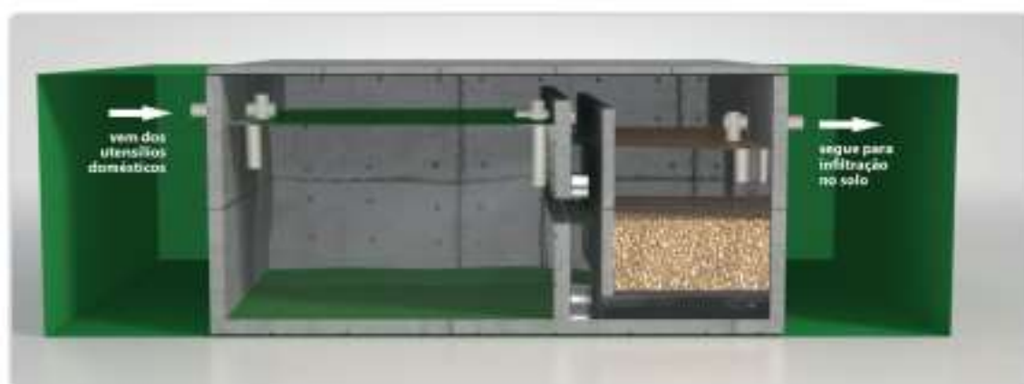
Figura 6-26 - Sistema fossa séptica e filtro biológico.
