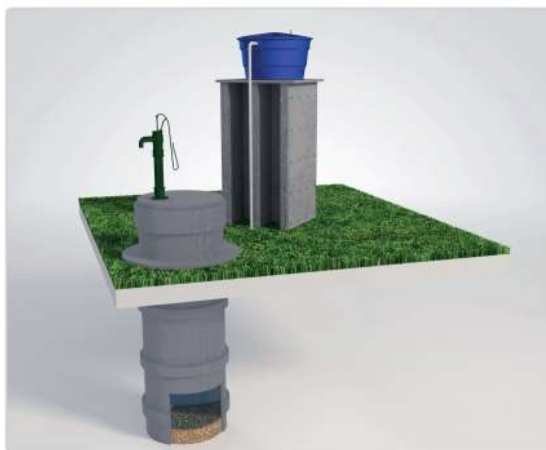
Figura 6-33 - Poço escavado protegido.
