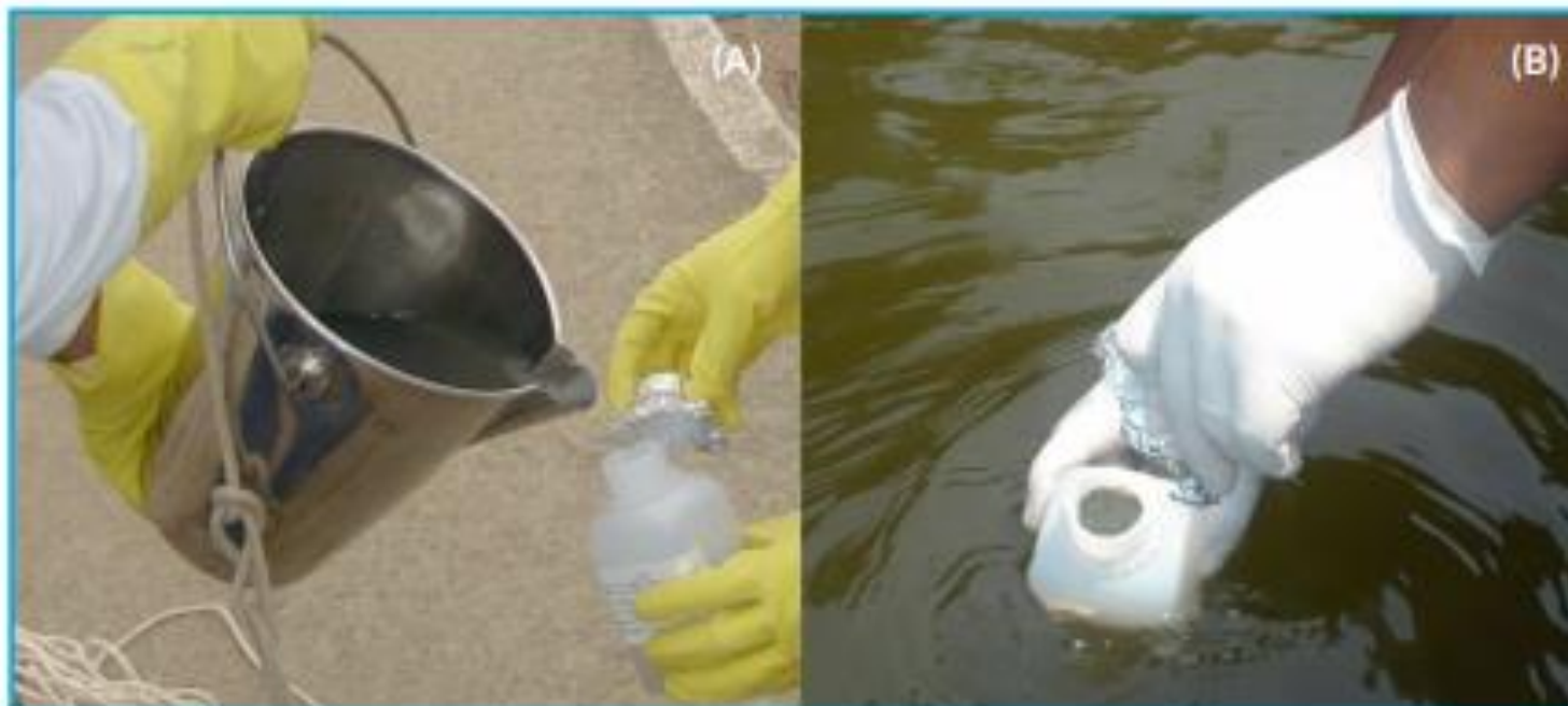
Figura 65. Coleta de amostra de água superficial para análise microbiológica: (A) com balde de aço inox; (B) diretamente do corpo d'água (Foto: Carlos Jesus Brandão/CETESB).
