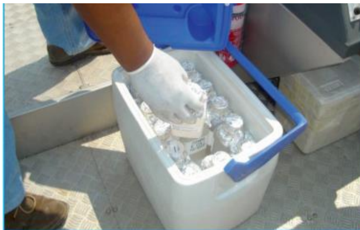
Figura 66. Acondicionamento e transporte de amostras para análises microbiológicas em caixa térmica sob refrigeração (Foto: Carlos Jesus Brandão/CETESB).
