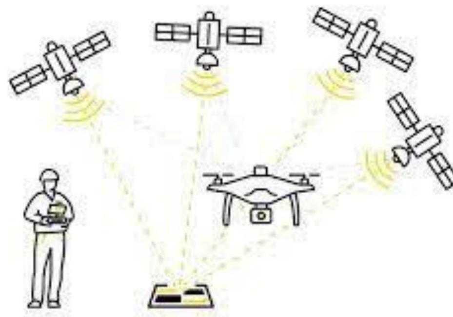
**Pontos de Controle:** Estabelecer pontos de controle terrestres com coordenadas conhecidas e visíveis nas imagens capturadas pelos drones ajuda a corrigir distorções e erros, aumentando a confiabilidade das medições.
