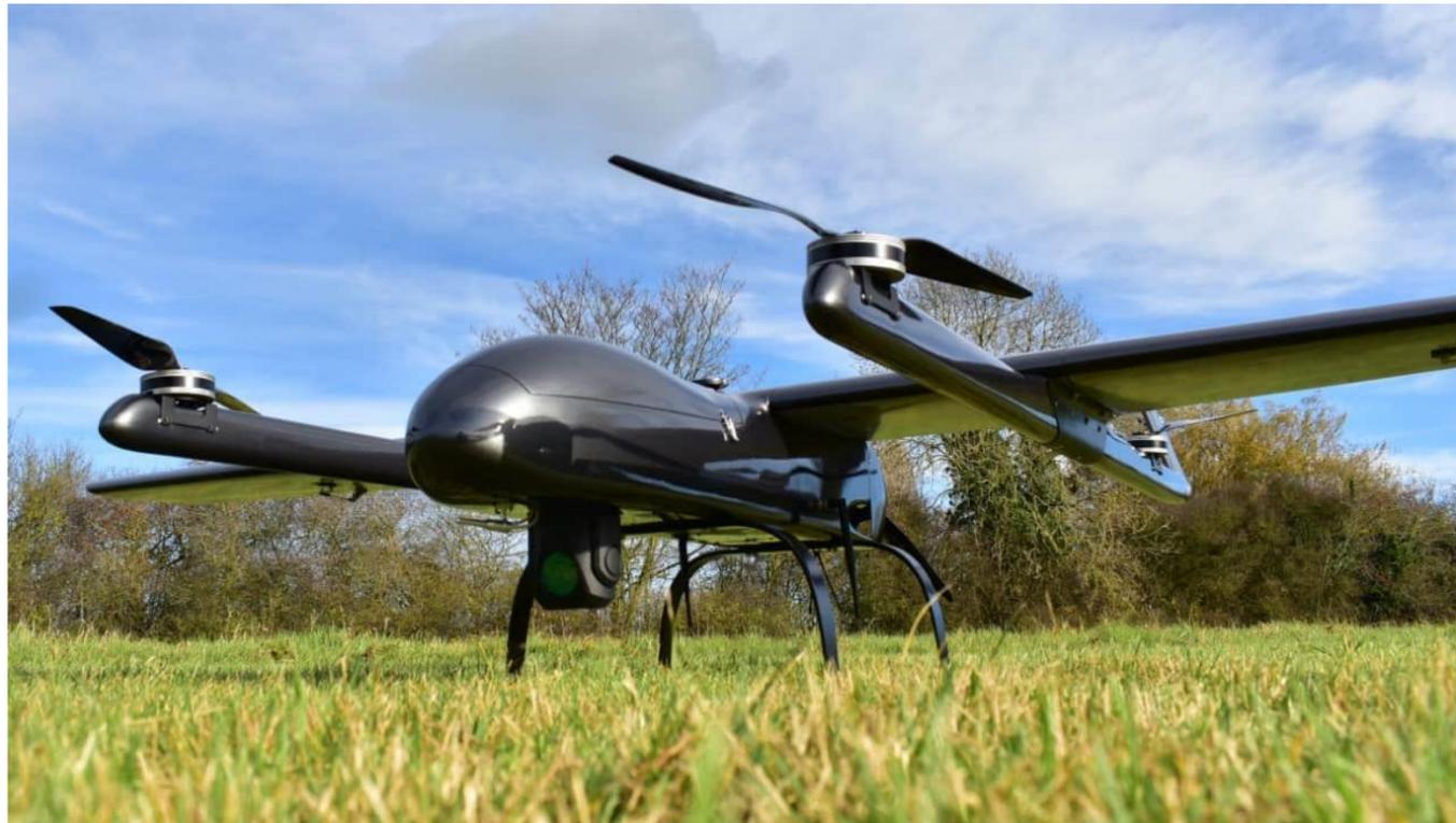
**Asa híbrida:** plataforma que utiliza tecnologia de aeronaves adaptáveis, considerada híbrida entre aeronaves de asa fixa e rotativa. Ainda operando em testes experimentais, é uma tendência de mercado para o futuro.
