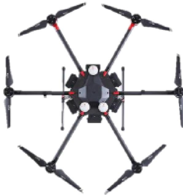
A principal vantagem do multirrotor é que ele mantém a capacidade de decolagem vertical e de voo pairado (estacionário/hover) de um helicóptero, mas com a simplicidade mecânica de um avião. O uso de múltiplos rotores elimina a necessidade de um mecanismo de rotor complexo encontrado em um helicóptero.
